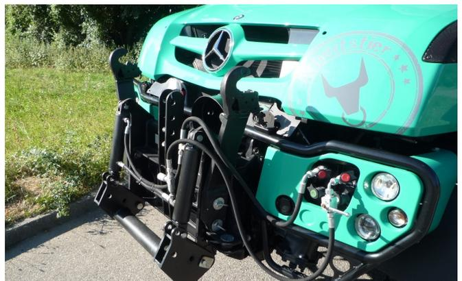
Frontkraftheber Fa. Söder SFL 1400/2200 mit 2200 kg durchgängiger Hubkraft =>
