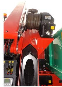
Kranseilwinde 1,5 to. Zugkraft
