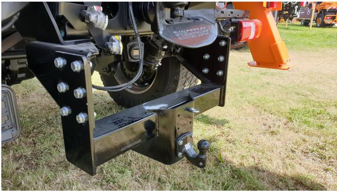
Kugelpfopf Anhängerkupplung mit 3500 kg Anhängelast
